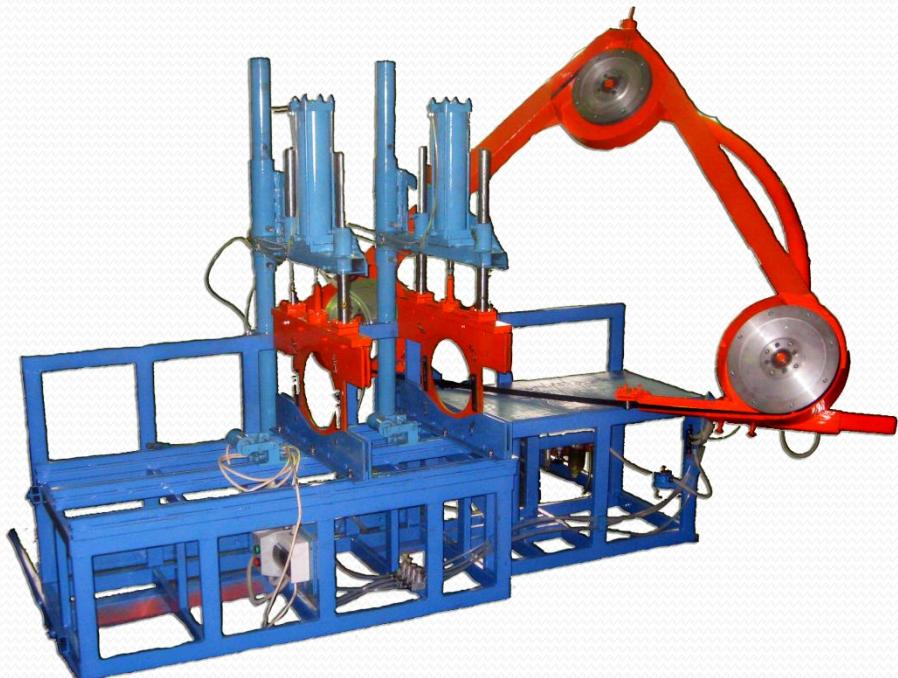
**Для резки труб до Ø 630 мм под углом
