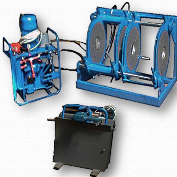
Для сварки труб Ø 90 - 315 мм
